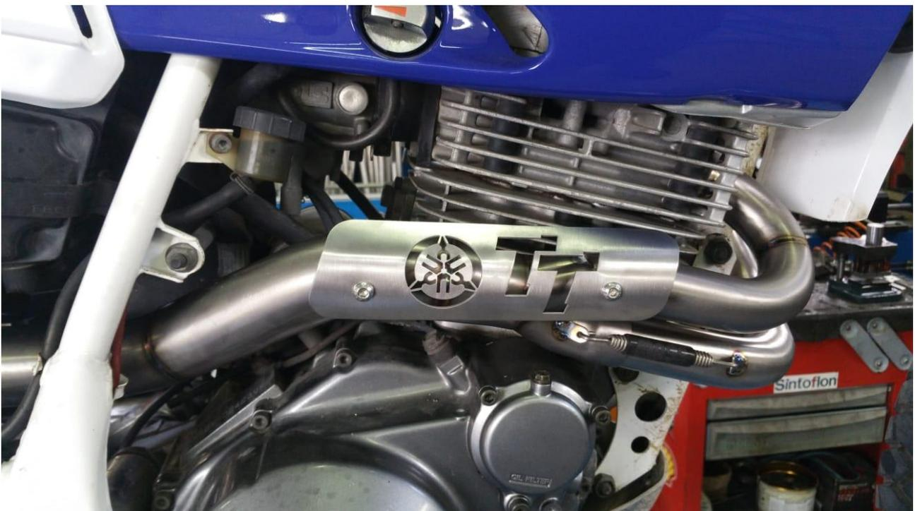
Alla prova fonometrica, l'impianto di scarico segnava da 91 a 95 decibel a 3000 giri, totalmente in linea con i dati riportati sul libretto di circolazione alla voce "dB controllo usati".
