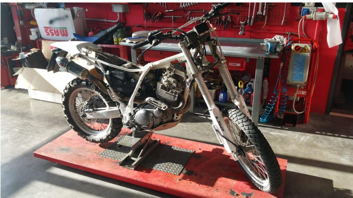
Iniziamo i lavori sostituendo il parafango anteriore, la mascherina porta faro completa di faro, frecce, verniciatura del serbatoio e dei convogliatori, montaggio fiancattine laterali trovate alla Yamaha nuove e il parafango posteriore che non essendo più in produzione, non rimane che restaurare il pezzo esistente...
