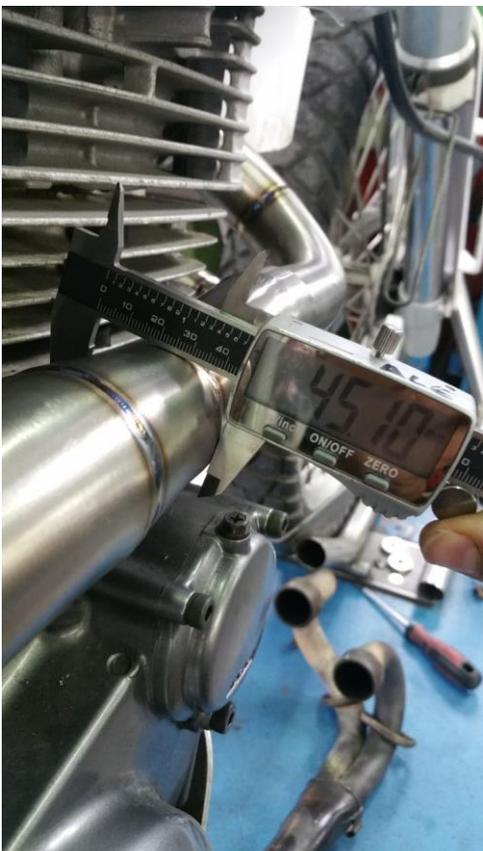
La conicità crescente dei collettori continua arrivando al diametro di 50 millimetri per poi imboccarsi direttamente nel terminale di scarico.
