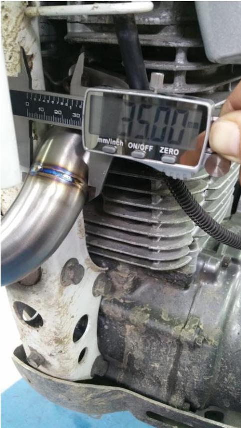
vanno ad imboccarsi in un collettore 2 in 1 che allarga il suo diametro fino a 45 millimetri.
