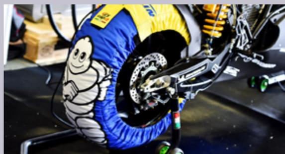
Ad ogni moto (foto) vengono forniti 2 set di termocoperte per gli pneumatici slick ed 1 set per gli pneumatici da pioggia
