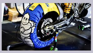
Ad ogni moto (foto) vengono forniti 2 set di termocoperte per gli pneumatici slick ed 1 set per gli pneumatici da pioggia
