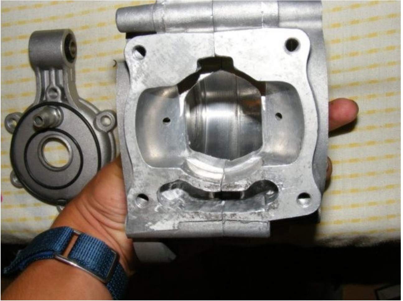
L'ampliamento della camera di raffreddamento combaciante col cilindro.
