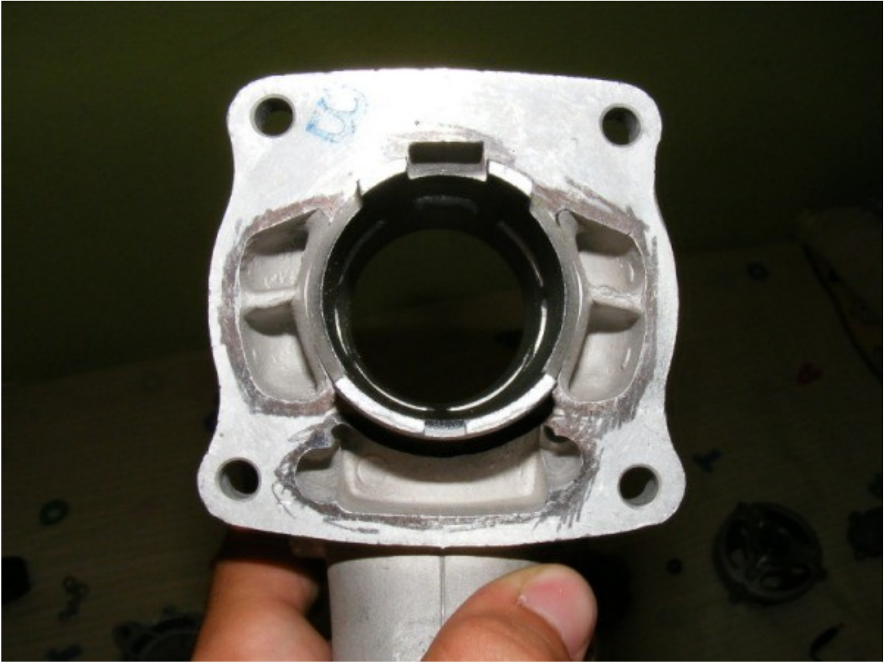
La sezione molto più ampia del cilindro.
